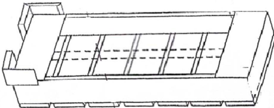
— La planche transversale en pointillés est optionnelle, le fabricant peut l'installer afin de renforcer la structure du fond du contenant en bois
